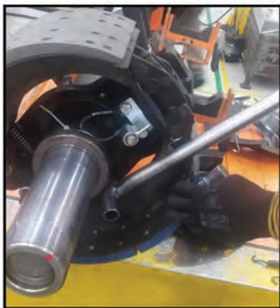
Figura 2 - Levante o patim inferior e retire a mola de retorno.
