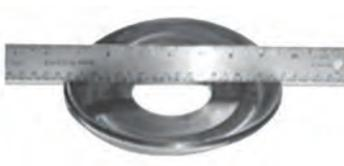
Um exemplo de arruela espaçadora "abaulada". O calor gerado por atrito faz com que o espaçador se "conforme" ou "cubra" ao redor do tubo da bucha. Isto é normal, desde que a arruela permaneça intacta e não fique cortado ou com alto desgaste.
