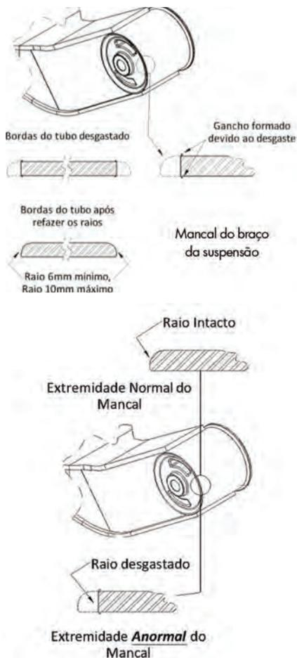
Também avalie as bordas do mancal do braço quanto ao desgaste. Algum desgaste (metal polido) nas bordas é considerado normal, produzido pelo movimento entre o braço e a suporte da suspensão. Se houver perda de metal e as bordas do mancal tenham sido desgastadas em demasiado, é considerado um desgaste anormal.
