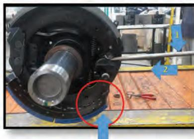
Obs 2: Para os freios que possuem mola de retorno com força maior, utilizando ferramenta para retirada da mesma conforme. Ponto 1 descer o instrumento, no Ponto 2 empurrar a ferramenta. E onde está circulado forçar para cima.
