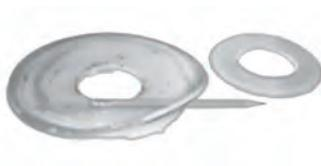
Exemplos de arruela espaçadora "desgastadas". A arruela à direita é um exemplo de desgaste extremo. Sua circunferência foi completamente cortada pelo tubo da bucha. O espaçador não está em condições de funcionamento e necessita substituição.
