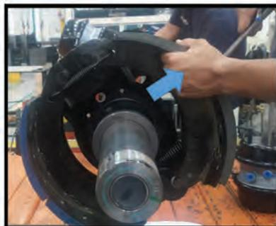
Obs 1: O Primeiro passo para a desmontagem dos freios 325mm modelo "Q" é retirar as molas de sujeição conforme demonstrado acima.
