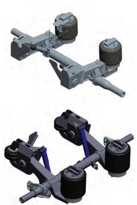
Nossa suspensão é projetada de forma a garantir alta quilometragem sem a necessidade de manutenção. No evento de algum problema menor, assim como uma falha no amortecedor ou no sistema pneumático, a suspensão dispõe de batentes internos às bolsas que permitem
